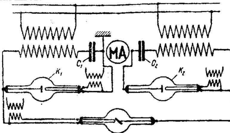
рис. №1. Электрическая схема аппарата РУП - 1.
