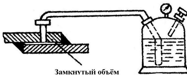
Рис. 8. Схема испытаний на плотность сварных швов воздухом
