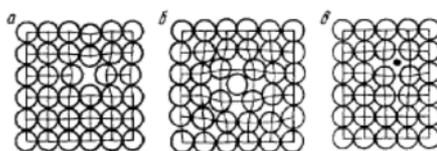
Рисунок 1.3 – Точечные дефекты в кристаллической решётке:
