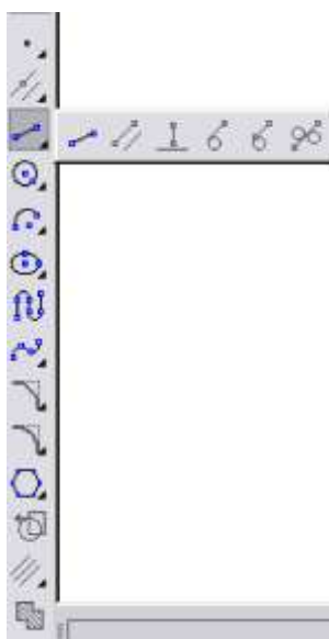
Рисунок 1.3 - Вид активированной панели расширенных команд при построении Отрезка
