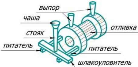
Рис. 3. Отливка с литниковой системой
