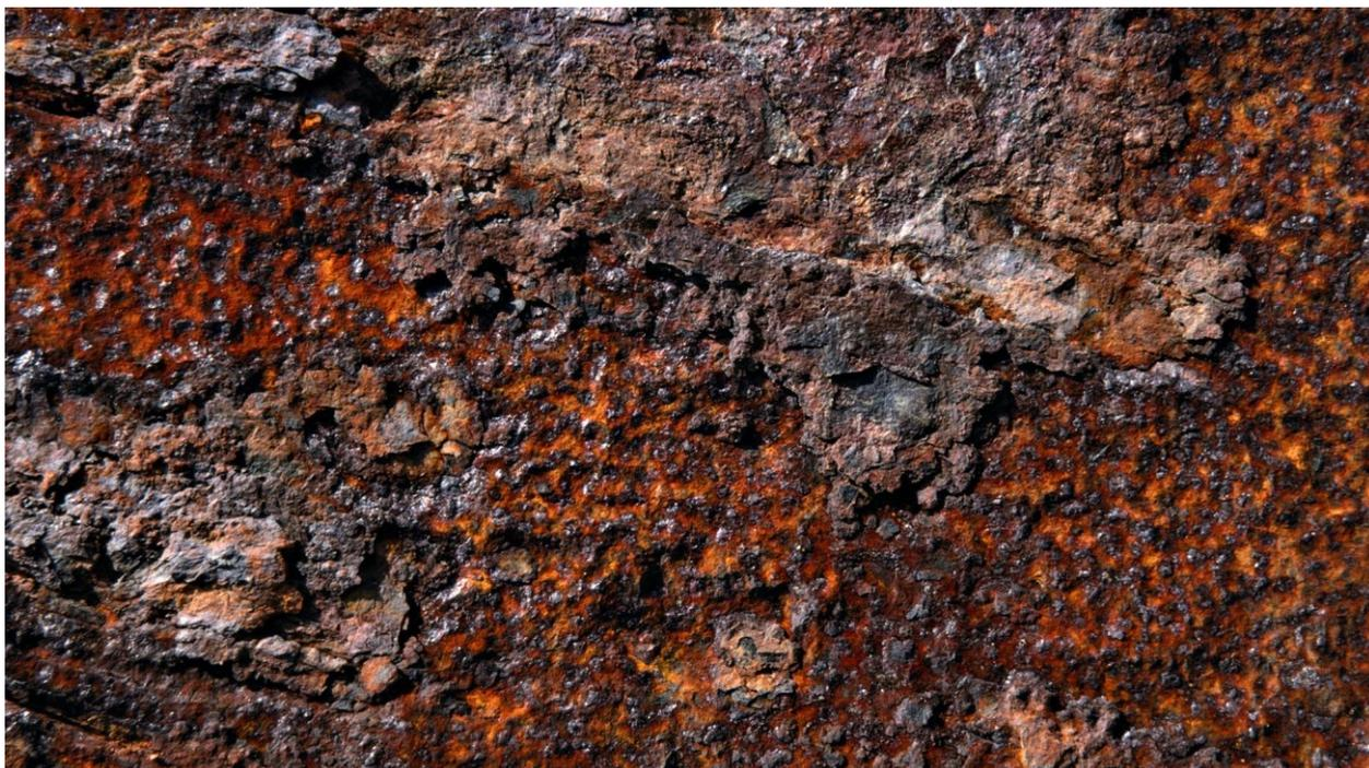
Рисунок 3 – Поверхность металла, покрытая ржавчиной
