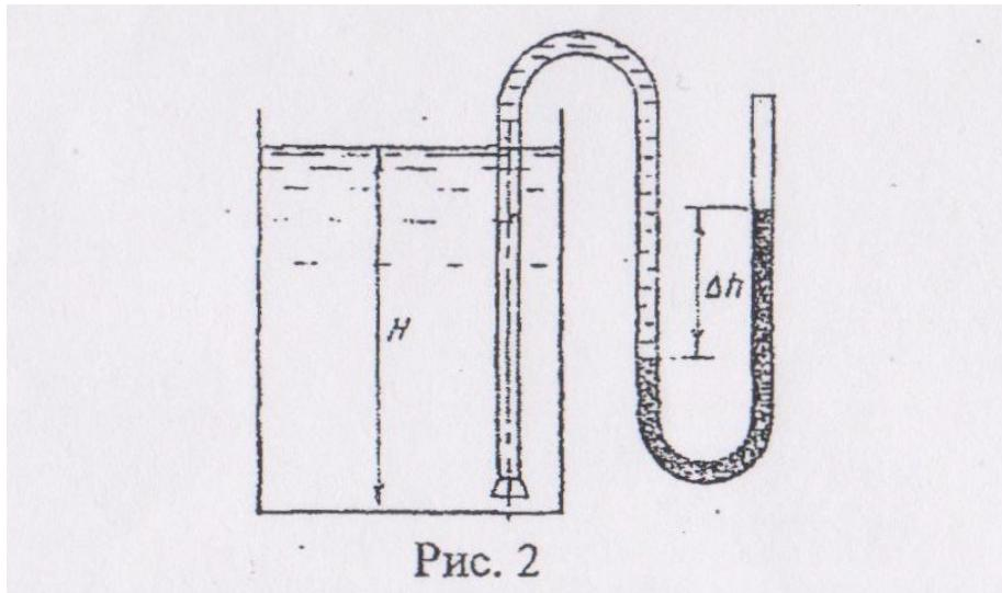
**3. Определить уровень мазута в баке (рис. 2), если при замере S — образной трубкой разность уровней ртути  $\Delta h = 250$  мм. Плотность мазута  $\rho_m = 860$  кг/м<sup>3</sup>.**
