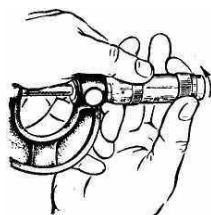
Рис.5 Закрепление барабана микрометра корпусом трещотки
