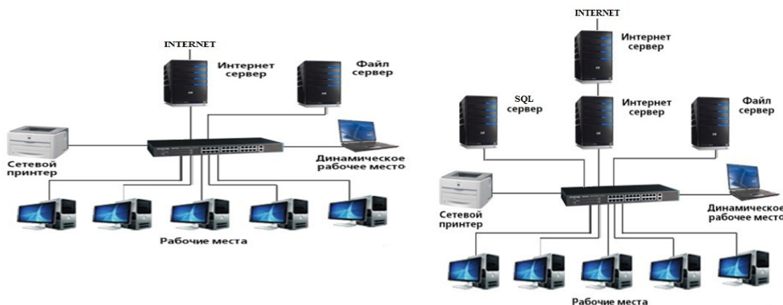
Рис.3. Пример построения сети с выделенным сервером и безопасным выходом в Интернет
