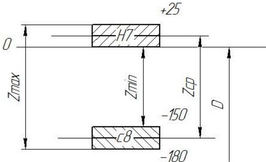
Обозначение на чертежах полей допусков, отверстия, вала, посадки.
