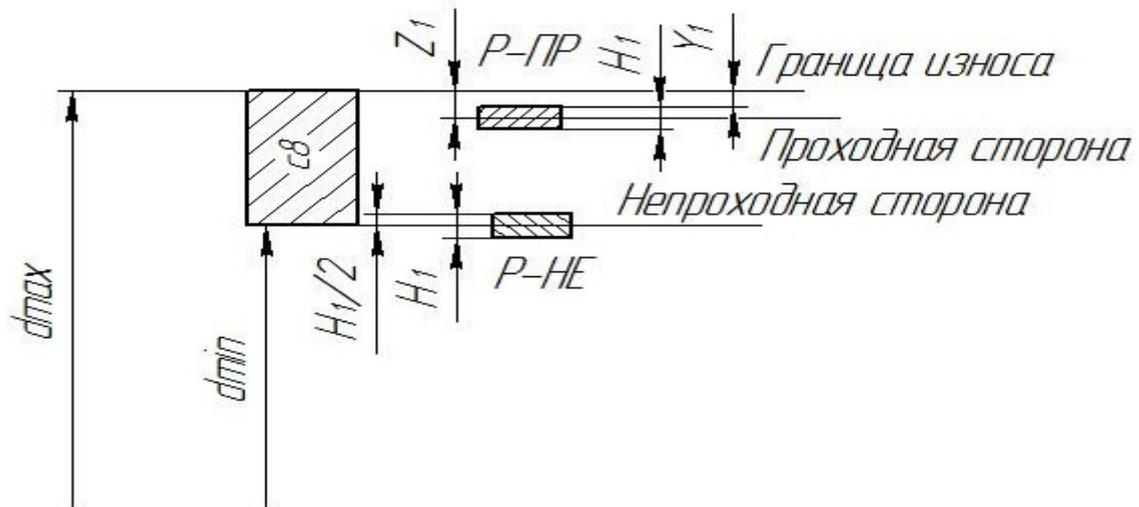
Эскиз калибр скобы с указанием исполнительных размеров и маркировки
