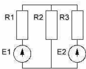
20. Определить токи, протекающие через резисторы, если  $E_1=120$  В,  $E_2=100$  В,  $R_1=80$  Ом,  $R_2=70$  Ом,  $R_3=50$  Ом.
