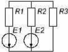
14. Рассчитать токи во всех ветвях электрической цепи методом наложения токов, если  $E_1=6\text{В}$ ,  $E_2=10\text{В}$ ,  $R_1=700\text{ Ом}$ ,  $R_2=300\text{ Ом}$ ,  $R_3=1100\text{ Ом}$ .
