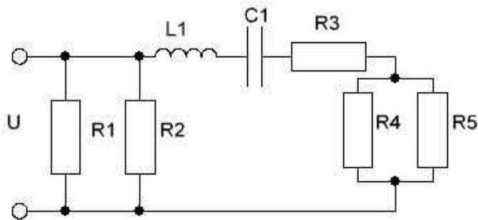
16. Для электрической цепи постоянного тока определить общий ток цепи и мощность потребляемую цепью, если  $R_1=12\text{ Ом}$ ,  $R_2=15\text{ Ом}$ ,  $R_3=20\text{ Ом}$ ,  $R_4=18\text{ Ом}$ ,  $R_5=10\text{ Ом}$ ,  $U=12\text{ В}$ .
