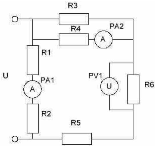
22. Для электрической цепи постоянного тока определить показания приборов, если  $R_1=60\ \text{Ом}$ ,  $R_2=30\ \text{Ом}$ ,  $R_3=40\ \text{Ом}$ ,  $R_4=70\ \text{Ом}$ ,  $R_5=20\ \text{Ом}$ ,  $R_6=10\ \text{Ом}$ ,  $U=150\ \text{В}$ .
