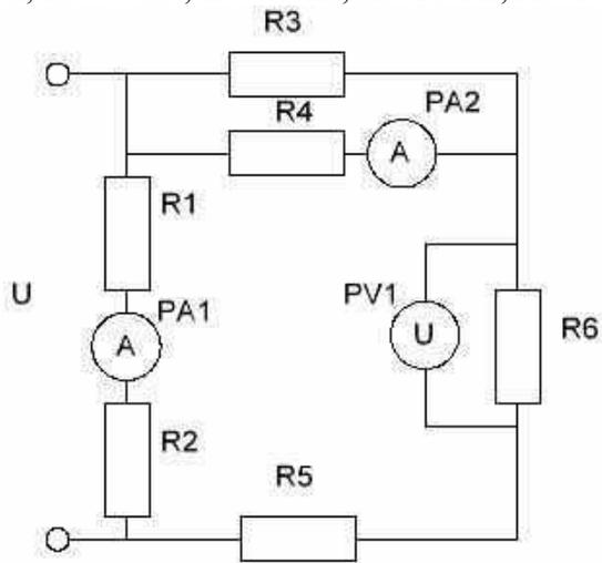
23. Для электрической цепи постоянного тока определить показания приборов, если  $R_1=40\ \text{Ом}$ ,  $R_2=20\ \text{Ом}$ ,  $R_3=30\ \text{Ом}$ ,  $R_4=50\ \text{Ом}$ ,  $R_5=10\ \text{Ом}$ ,  $R_6=5\ \text{Ом}$ ,  $R_7=5\ \text{Ом}$ ,  $U=60\ \text{В}$ .
