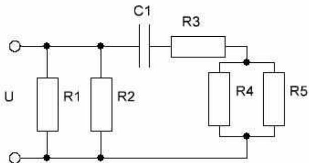
15. Определить мощность, потребляемую цепью постоянного тока, если  $R_1=12\ \text{Ом}$ ,  $R_2=15\ \text{Ом}$ ,  $R_3=20\ \text{Ом}$ ,  $R_4=18\ \text{Ом}$ ,  $R_5=10\ \text{Ом}$ ,  $L_1=0,5\ \text{Гн}$ ,  $C_1=10\ \text{мкФ}$ ,  $U=12\ \text{В}$ .
