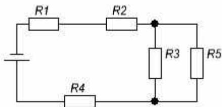
2. Определить общее сопротивление электрической цепи, напряжение и мощность каждого проводника при  $R_1=5$  Ом,  $R_2=15$  Ом,  $R_3=30$  Ом,  $R_4=12$  Ом,  $R_5=20$  Ом. Напряжение источника питания 24 В.
