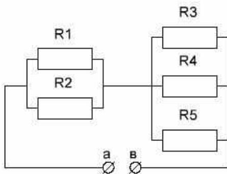
18. Определить напряжение, приложенное к контактам а и в и потребляемую мощность для цепи постоянного тока, если,  $R_1=10\text{ Ом}$ ,  $R_2=30\text{ Ом}$ ,  $R_3=10\text{ Ом}$ ,  $R_4=30\text{ Ом}$ ,  $R_5=50\text{ Ом}$ ,  $R_6=60\text{ Ом}$ ,  $I_{\text{общ}}=10\text{ А}$ .
