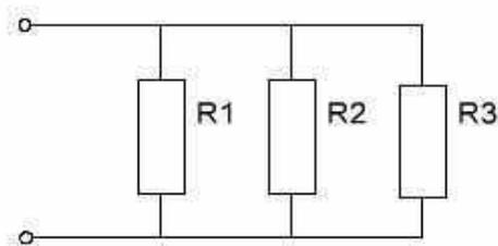
4. В домашнюю розетку через удлинитель включены телевизор мощностью 100 Вт, пылесос мощностью 1,5 кВт и СВЧ печь мощностью 1,5 кВт. Определить общий ток и ток каждого потребителя.
