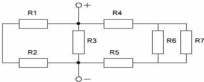
7. Рассчитать мощность, потребляемую цепью, состоящую из  $R_1=5 \text{ Ом}$ ,  $R_2=10 \text{ Ом}$ ,  $R_3=15 \text{ Ом}$ ,  $R_4=10 \text{ Ом}$ ,  $R_5=25 \text{ Ом}$ ,  $R_6=30 \text{ Ом}$ ,  $U=12 \text{ В}$ .
