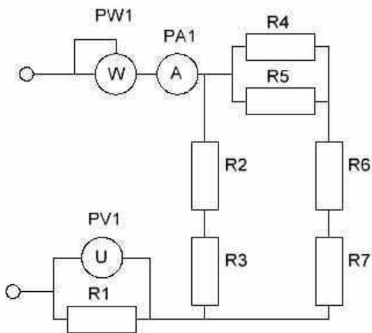
24. Для электрической цепи постоянного тока определить показания приборов, если  $R_1=45\ \text{Ом}$ ,  $R_2=25\ \text{Ом}$ ,  $R_3=35\ \text{Ом}$ ,  $R_4=55\ \text{Ом}$ ,  $R_5=15\ \text{Ом}$ ,  $R_6=10\ \text{Ом}$ ,  $R_7=15\ \text{Ом}$ ,  $U=30\ \text{В}$ .
