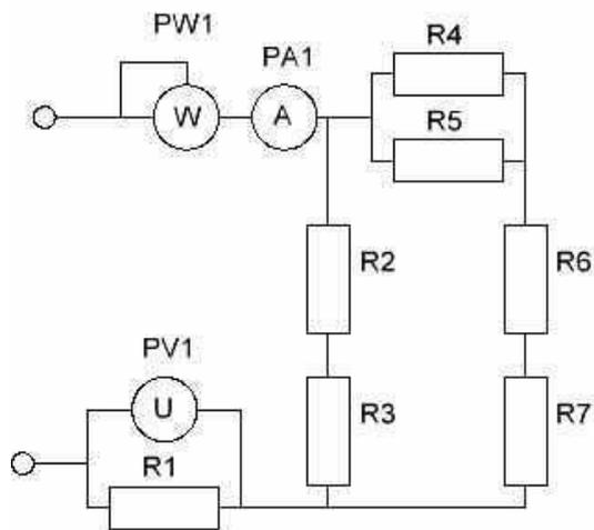
25. Для электрической цепи постоянного тока определить показания приборов, если  $R_1=60 \text{ Ом}$ ,  $R_2=80 \text{ Ом}$ ,  $R_3=90 \text{ Ом}$ ,  $R_4=100 \text{ Ом}$ ,  $R_5=10 \text{ Ом}$ ,  $U=100 \text{ В}$ .
