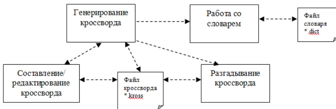
Рисунок 1 – Диаграмма модулей системы (фрагмент)
