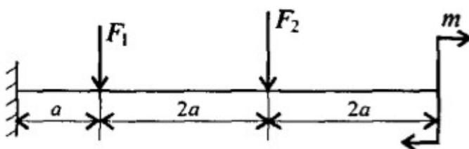
Для консольной балки нагруженной сосредоточенными силами  $F_1=28$  кН,  $F_2=24$  кН и парой сил и моментом  $M=4$  кН\*м, построить эпюры поперечных сил и изгибающих моментов. Материал –сталь,  $[\sigma]=160$  МПа,  $a=0,6$  м.
