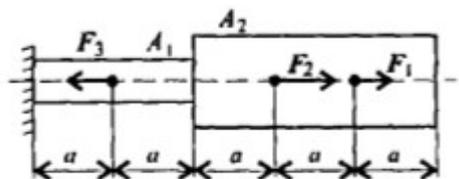
Построить эпюры продольных сил и нормальных напряжений по длине бруса. Определить перемещение свободного конца бруса. Двухступенчатый стальной брус нагружен силами  $F_1=26$  кН,  $F_2=20$  кН,  $F_3=10$  кН. Площади поперечных сечений  $A_1=1,6$  см<sup>2</sup>,  $A_2=2,4$  см<sup>2</sup>.  $a=0,3$  м. Принять  $E=2 \cdot 10^5$  Н/мм<sup>2</sup>.
