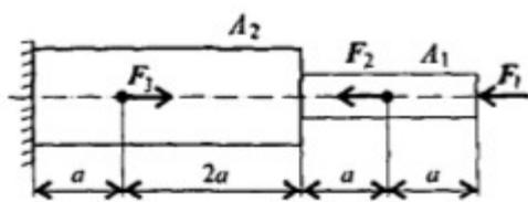
Построить эпюры продольных сил и нормальных напряжений по длине бруса. Определить перемещение свободного конца бруса. Двухступенчатый стальной брус нагружен силами  $F_1=2$  кН,  $F_2=3$  кН,  $F_3=5$  кН. Площади поперечных сечений  $A_1=2$  см<sup>2</sup>,  $A_2=4$  см<sup>2</sup>.  $a=0,2$  м. Принять  $E=2 \cdot 10^5$  Н/мм<sup>2</sup>.
