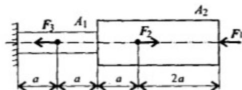
Построить эпюры продольных сил и нормальных напряжений по длине бруса. Определить перемещение свободного конца бруса. Двухступенчатый стальной брус нагружен силами  $F_1=10$  кН,  $F_2=12$  кН,  $F_3=13$  кН. Площади поперечных сечений  $A_1=0,9$  см<sup>2</sup>,  $A_2=1,7$  см<sup>2</sup>.  $a=0,4$  м. Принять  $E=2 \cdot 10^5$  Н/мм<sup>2</sup>.
