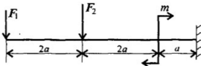
Для консольной балки нагруженной сосредоточенными силами  $F_1=26$  кН,  $F_2=22$  кН и парой сил и моментом  $M=5$  кН\*м, построить эпюры поперечных сил и изгибающих моментов. Материал –сталь,  $[\sigma]=160$  МПа,  $a=0,6$  м.
