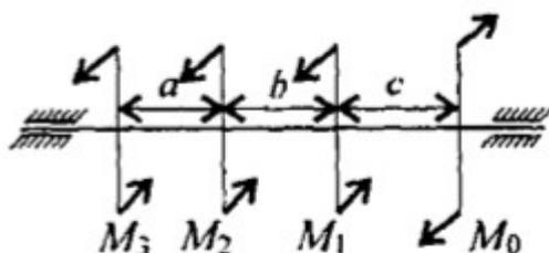
Для стального вала круглого поперечного сечения определить значения внешних моментов, соответствующих передаваемым мощностям  $P_1=2,1$  кВт,  $P_2=2,6$  кВт,  $P_3=3,1$  кВт, и уравновешенный момент. Построить эпюру крутящих моментов по длине вала для предложенной схемы. При расчете
