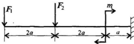
Для консольной балки нагруженной сосредоточенными силами  $F_1 = 16 \text{ кН}$ ,  $F_2 = 8 \text{ кН}$  и парой сил и моментом  $M = 5 \text{ кН*м}$ , построить эпюры поперечных сил и изгибающих моментов. Материал –сталь,  $[\sigma] = 160 \text{ МПа}$ ,  $a = 0,3 \text{ м}$ .
