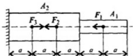
Построить эпюры продольных сил и нормальных напряжений по длине бруса. Определить перемещение свободного конца бруса. Двухступенчатый стальной брус нагружен силами  $F_1=20$  кН,  $F_2=8$  кН,  $F_3=4$  кН. Площади поперечных сечений  $A_1=1$  см<sup>2</sup>,  $A_2=1,5$  см<sup>2</sup>.  $a=0,4$  м. Принять  $E=2 \cdot 10^5$  Н/мм<sup>2</sup>.
