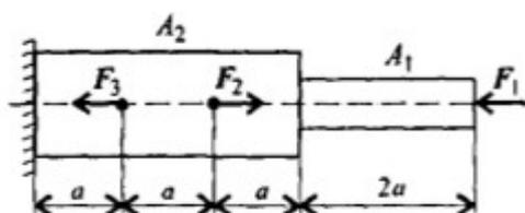
Построить эпюры продольных сил и нормальных напряжений по длине бруса. Определить перемещение свободного конца бруса. Двухступенчатый стальной брус нагружен силами  $F_1=17$  кН,  $F_2=13$  кН,  $F_3=8$  кН. Площади поперечных сечений  $A_1=2$  см<sup>2</sup>,  $A_2=2,5$  см<sup>2</sup>.  $a=0,5$  м. Принять  $E=2 \cdot 10^5$  Н/мм<sup>2</sup>.
