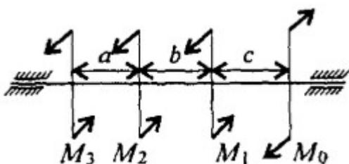
$[\tau_k] = 30 \text{ МПа}$ ,  $G = 8 \cdot 10^4 \text{ МПа}$ ,  $[\varphi] = 0,02 \text{ рад/м}$ ,  $a = b = c = 1,4 \text{ м}$ .
