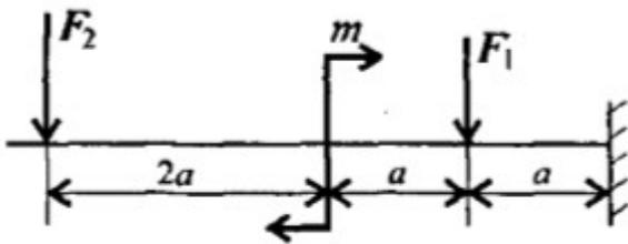
Для консольной балки нагруженной сосредоточенными силами  $F_1 = 12 \text{ кН}$ ,  $F_2 = 5 \text{ кН}$  и парой сил и моментом  $M = 7 \text{ кН*м}$ , построить эпюры поперечных сил и изгибающих моментов. Материал –сталь,  $[\sigma] = 160 \text{ МПа}$ ,  $a = 0,2 \text{ м}$ .
