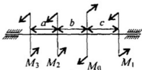
материал-сталь,  $[\tau_k] = 30 \text{ МПа}$ ,  $G = 8 \cdot 10^4 \text{ МПа}$ ,  $[\varphi] = 0,02 \text{ рад/м}$ ,  $a = b = c = 1,3 \text{ м}$ .
