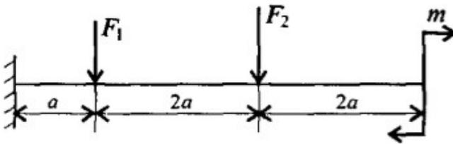
Для консольной балки нагруженной сосредоточенными силами  $F_1 = 14 \text{ кН}$ ,  $F_2 = 8 \text{ кН}$  и парой сил и моментом  $M = 6 \text{ кН*м}$ , построить эпюры поперечных сил и изгибающих моментов. Материал –сталь,  $[\sigma] = 160 \text{ МПа}$ ,  $a = 0,3 \text{ м}$ .
