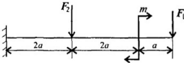
Для консольной балки нагруженной сосредоточенными силами  $F_1 = 10 \text{ кН}$ ,  $F_2 = 4 \text{ кН}$  и парой сил и моментом  $M = 8 \text{ кН*м}$ , построить эпюры поперечных сил и изгибающих моментов. Материал –сталь,  $[\sigma] = 160 \text{ МПа}$ ,  $a = 0,2 \text{ м}$ .
