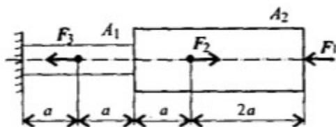
Построить эпюры продольных сил и нормальных напряжений по длине бруса. Определить перемещение свободного конца бруса. Двухступенчатый стальной брус нагружен силами  $F_1=12$  кН,  $F_2=7$  кН,  $F_3=13$  кН. Площади поперечных сечений  $A_1=0,5$  см<sup>2</sup>,  $A_2=1,2$  см<sup>2</sup>.  $a=0,2$  м. Принять  $E=2 \cdot 10^5$  Н/мм<sup>2</sup>.
