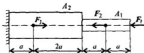
Построить эпюры продольных сил и нормальных напряжений по длине бруса. Определить перемещение свободного конца бруса. Двухступенчатый стальной брус нагружен силами  $F_1=20$  кН,  $F_2=10$  кН,  $F_3=5$  кН. Площади поперечных сечений  $A_1=1,8$  см<sup>2</sup>,  $A_2=3,2$  см<sup>2</sup>.  $a=0,2$  м. Принять  $E=2 \cdot 10^5$  Н/мм<sup>2</sup>.
