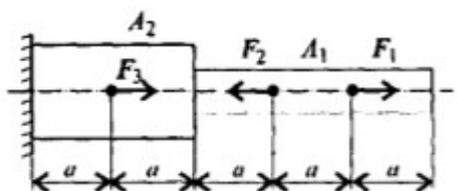
Построить эпюры продольных сил и нормальных напряжений по длине бруса. Определить перемещение свободного конца бруса. Двухступенчатый стальной брус нагружен силами  $F_1=16$  кН,  $F_2=20$  кН,  $F_3=28$  кН. Площади поперечных сечений  $A_1=1,2$  см<sup>2</sup>,  $A_2=2,8$  см<sup>2</sup>.  $a=0,6$  м. Принять  $E=2 \cdot 10^5$  Н/мм<sup>2</sup>.
