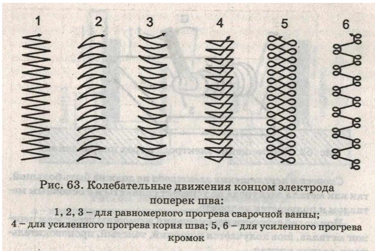
Поперечные колебательные движения конца электрода определяются формой разделки , размерами и положением шва , свойствами свариваемого материала , навыком сварщика. Техника выполнения зависит от вида и пространственного положения шва.
