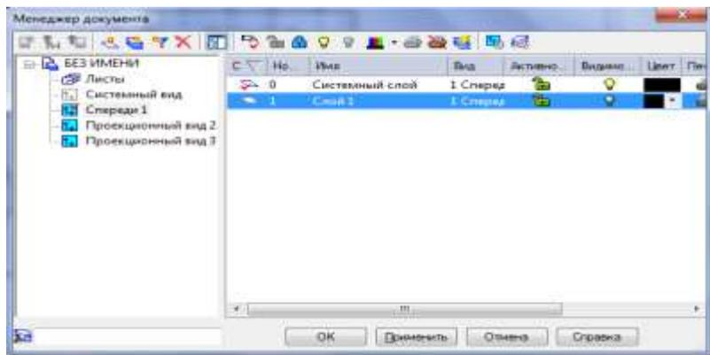
Следующий шаг – выделяем на чертеже элементы, которые на разрезе не нужны – линии контура детали, невидимые отверстия. Помещаем их в слой 1 – нажимаем правую кнопку мыши и выбираем команду Изменить слой, выбираем слой 1.
