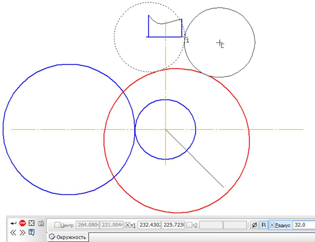
Рисунок 11. Построение касательной окружности радиусом 32 мм
