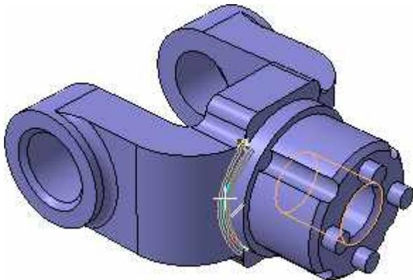
Остальные ребра гладко сопряжены с указанным ребром. Откройте вкладку Параметры на Панели свойств. Обратите внимание на включенную опцию По касательным ребрам — она обеспечит автоматическое скругление остальных ребер.
