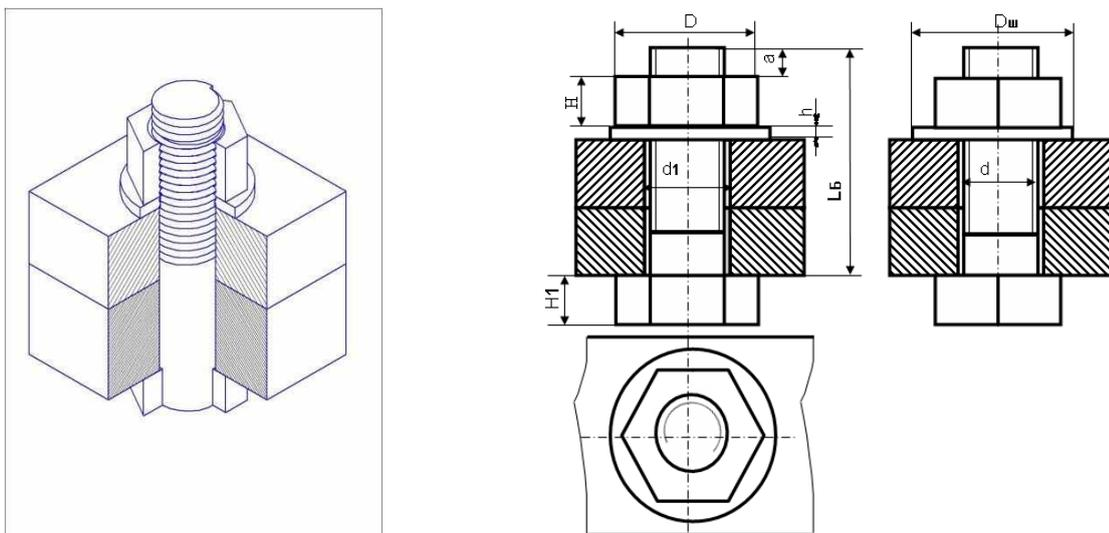
Рисунок 68. Болтовое соединение
