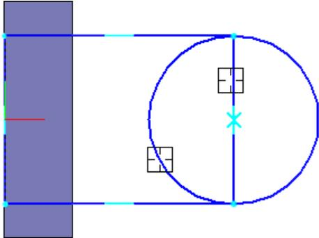
Для того, чтобы получить правильный контур, необходимо вручную добавить параметрические связи между его элементами.
