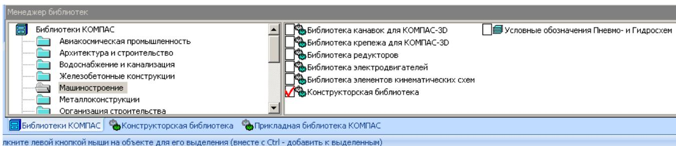
Предварительно необходимо определить положение базовой точки элемента на чертеже. В открывшейся библиотеке выбирается и устанавливается выбранный элемент. Параметры элемента можно менять.
