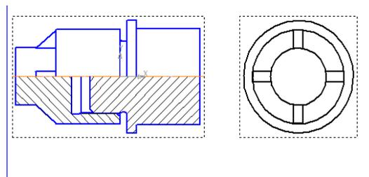
**Ребро жесткости, попавшее в продольный разрез, не штрихуется.**
