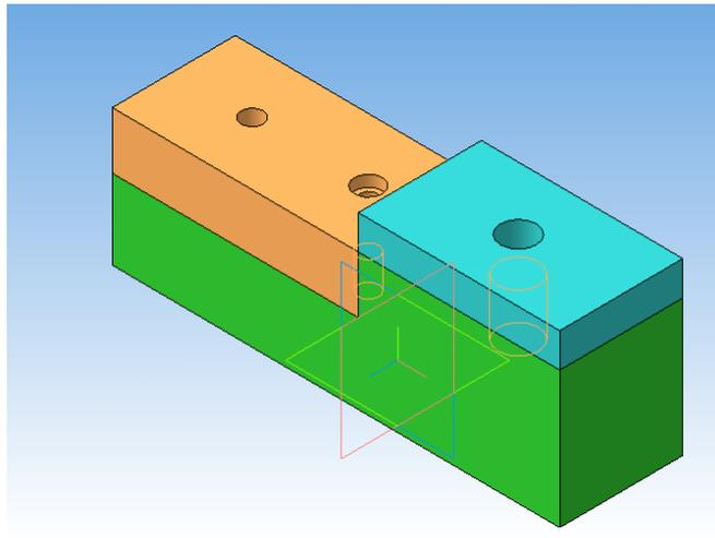
12. Теперь последовательно вставляйте в сборку болтовое соединение, винт и шпилечное соединение.
