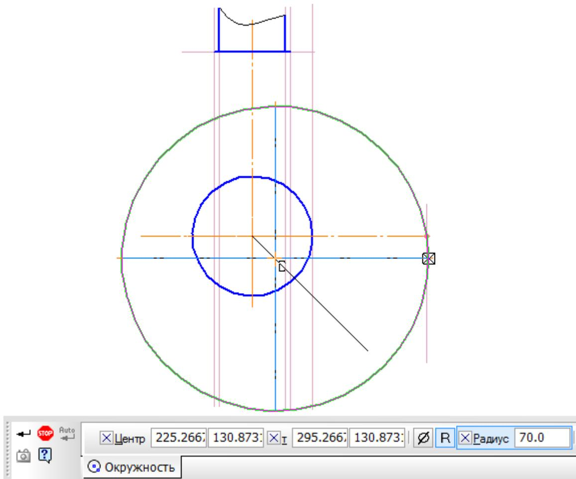
Рисунок 9. Построение окружности радиусом 70 мм
