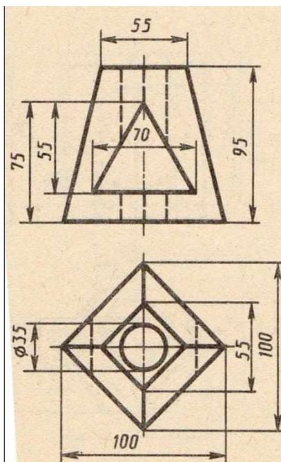
Геометрическое тело представляет собой усеченную пирамиду с двумя отверстиями –цилиндрическим и призматическим.
