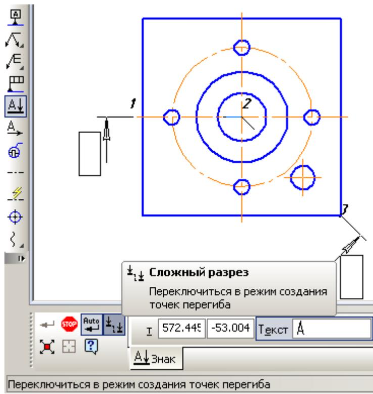
Рисунок 66. Оформление сложного разреза
