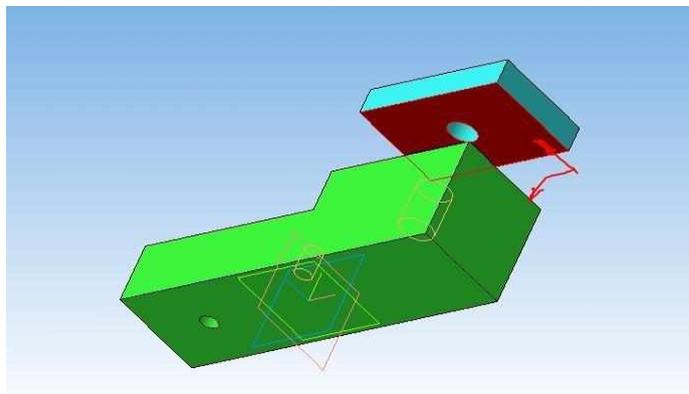
11. Таким же образом поступаем и с пластиной. Сначала задайте соосность одного из отверстий в пластине и основании, а затем совпадение объектов.
