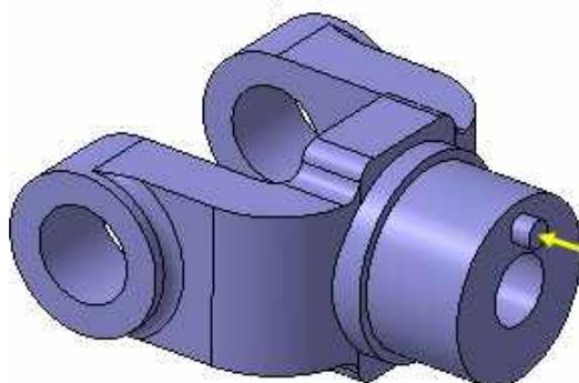
Нажмите кнопку Массив по концентрической сетке
