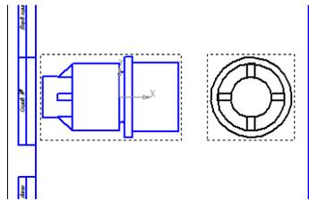
Соединим часть вида спереди с частью фронтального разреза при помощи [команды Местный разрез](#)
