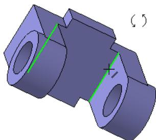
В поле Радиус на Панели свойств, с помощью
