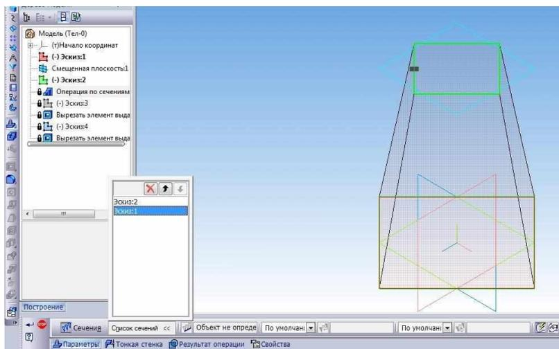
7. Пирамида построена. Остается только вырезать выдавливанием окружность диаметром 35 мм и призматическое отверстие.
