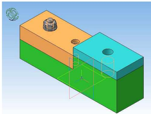
17. Добавьте в сборку винт. Задайте соосность стержня винта с отверстием в основании и совпадение с «дном» отверстия диаметром 12,5 мм.
