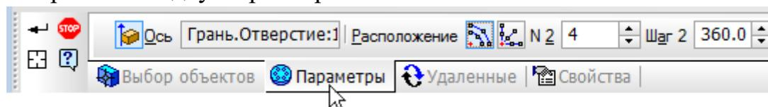
Для определения оси массива укажите цилиндрическую грань отверстия — в качестве оси массива будет использоваться ось выбранной грани.
