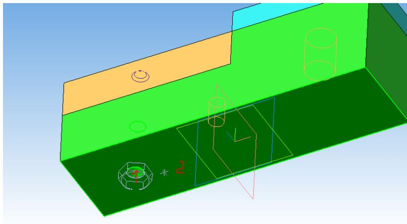
15. Аналогично вставьте шайбу, задав соосность отверстия в шайбе со стержнем болта и совпадение поверхности основания с шайбой.
