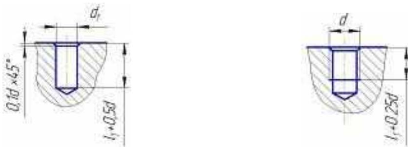
Рисунок 71. Изображение гнезд под шпильку
