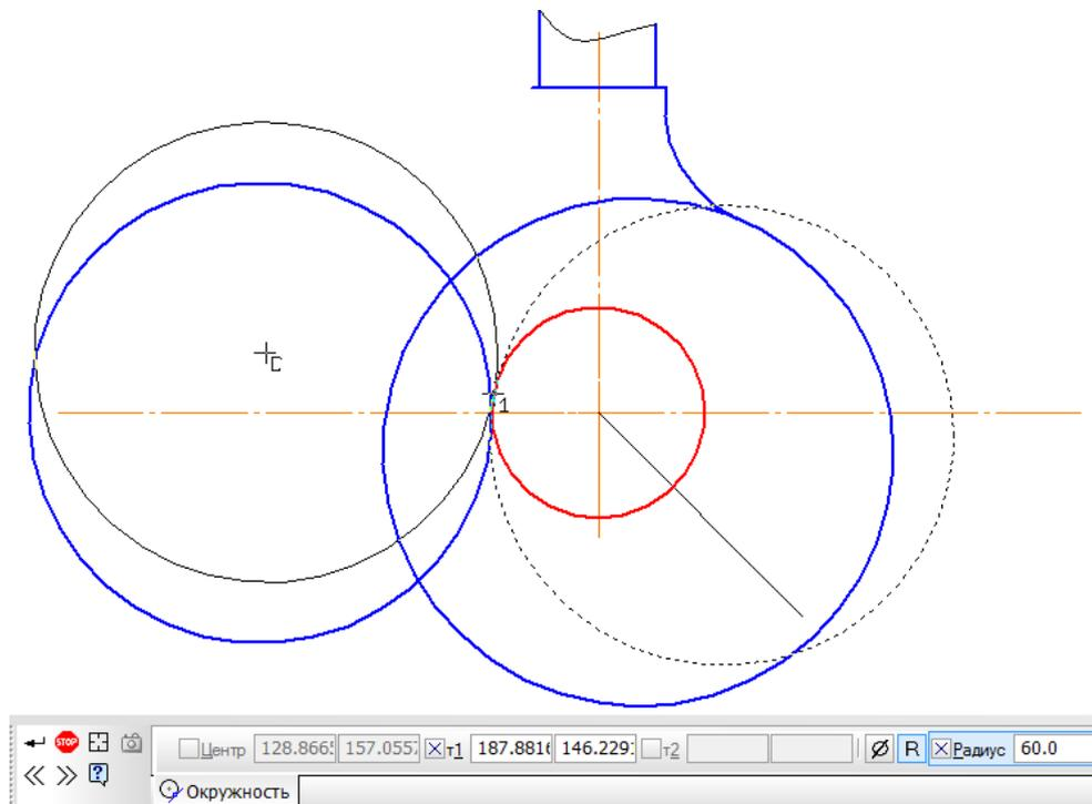
Рисунок 12. Построение касательных окружностей R 60 мм
