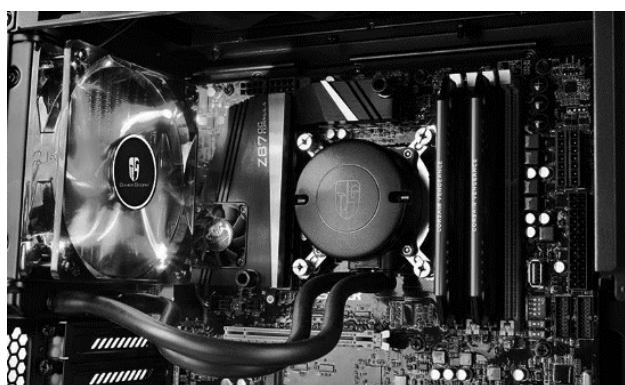
Рисунок 3 – Система жидкостного охлаждения ЦП.
