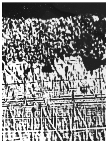
Рисунок 2 – Изображение микрошлифа алюминиевого поверхностного слоя на образце
